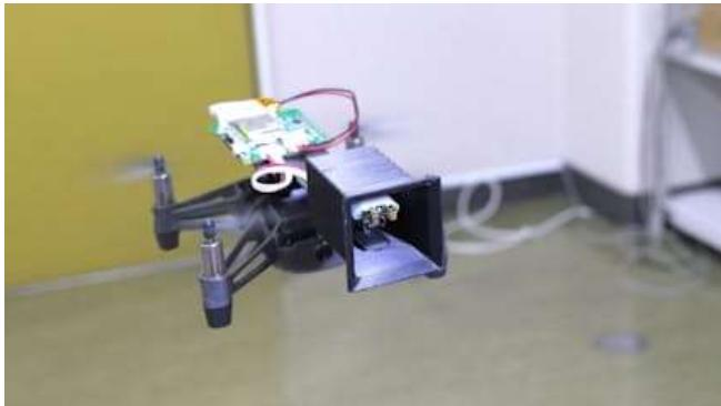
カイコガの触角センサーを搭載した小型ドローンは、自律飛行しフェロモン源を探し出すことに成功している=信州大の照月大悟准教授提供
